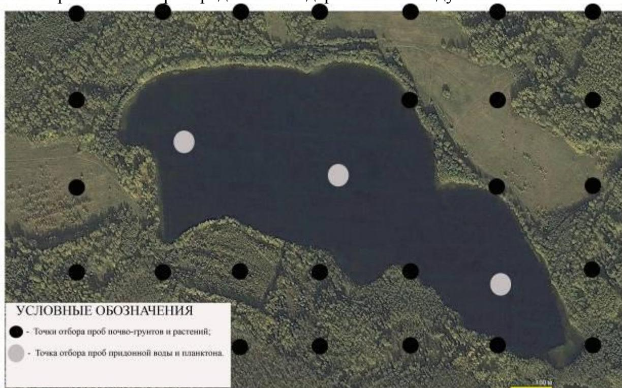
**Рисунок 6.6.1.** Схема расположения точек пробоотбора грунтов, придонных вод и планктона.
